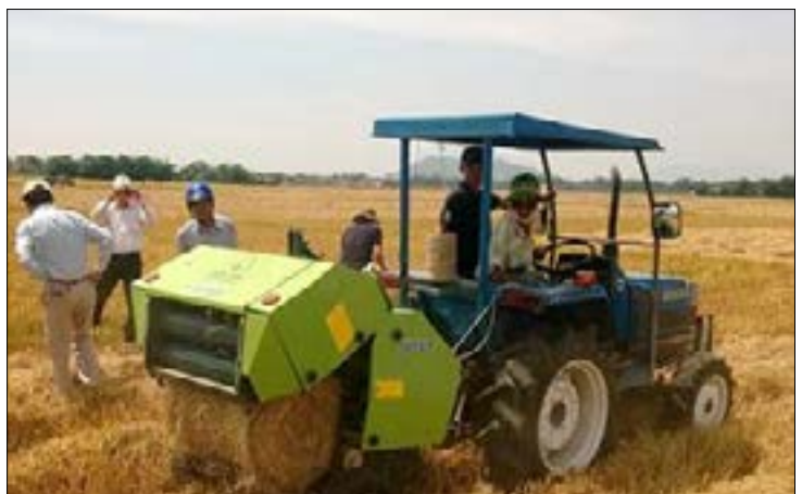
▲ Nông dân An Giang sử dụng máy cuốn rơm phục vụ sản xuất nông nghiệp
